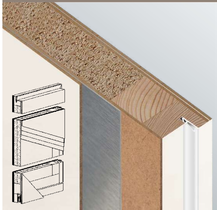
Türblattaufbau mit Aluminiumverbundabsperung
